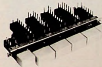
6 TOETS SCHAKELAAR Toetsen - grijs plastic 4 toetsen 6x wissel (zelflossend) 1 toets 2x wissel (niet zelflossend) 1 toets 4x wissel (niet zelflossend) f 3,50
